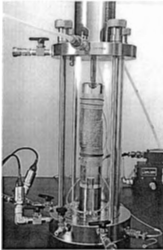
Figur 2. Den minsta cellen för prover med en diameter av 50 mm och en höjd av 100 mm.
