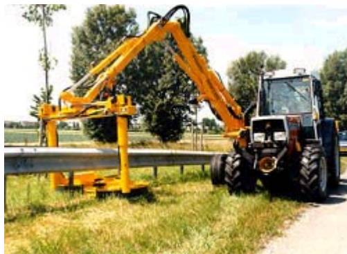
Figur 2.11 Specialaggregat för klippning runt vägräcke.
