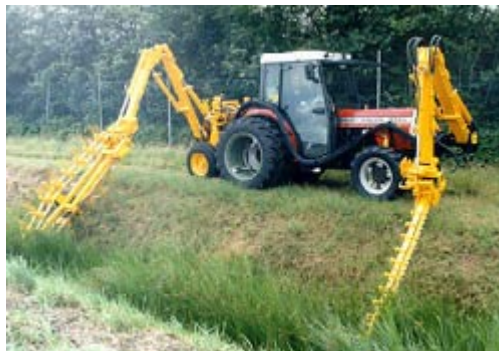
Figur 2.10 Maskin med dubbla klippaggregat, för klippning av dikesbotten respektive dikesslätten.
