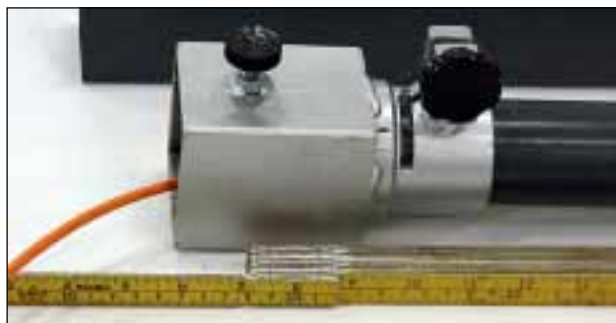
Figur 14 – Detalj adapter mellan 4-kantsrör och cirkulära rör.
